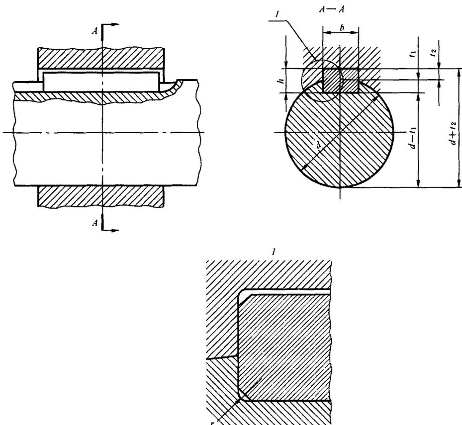
图 1 普通平键键槽的剖面尺寸
